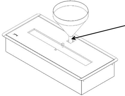
Pour recharger le brûleur en combustible, appuyer suffisamment fort sur la trappe d'alimentation, pour provoquer une action des ressorts et ainsi créer une ouverture dans laquelle sera versé le bioéthanol. Une fois le brûleur rechargé, la trappe se referme automatiquement.
