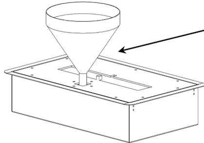
Pour recharger le brûleur en combustible, appuyer suffisamment fort sur la trappe d'alimentation, pour provoquer une action des ressorts et ainsi créer une ouverture dans laquelle sera versé le bioéthanol. Une fois le brûleur rechargé, la trappe se referme automatiquement.
