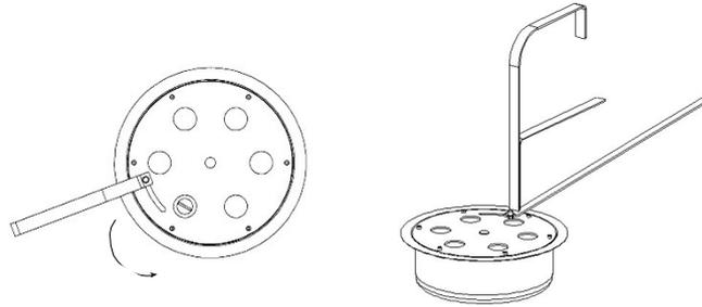
Pour régler le brûleur, manipuler systématiquement la clé par l'extrémité opposée à celle en contact avec le brûleur.
