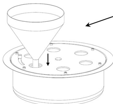
Pour recharger le brûleur en combustible, appuyer suffisamment fort sur la trappe d'alimentation, pour provoquer une action des ressorts et ainsi créer une ouverture dans laquelle sera versé le bioéthanol. Une fois le brûleur rechargé, la trappe se referme automatiquement.
