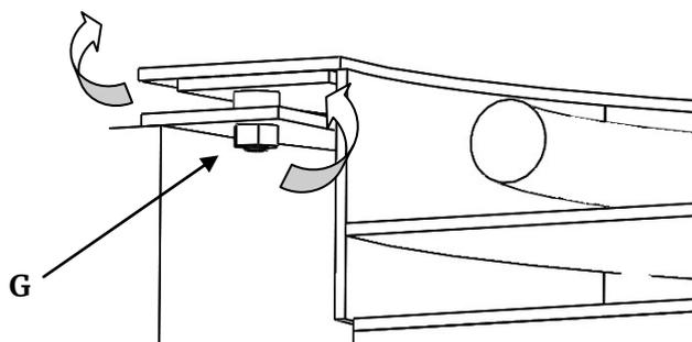
Remarque: le brûleur à gaz est équipé de ses propres entretoises (G) afin d'éviter toute installation incorrecte (obstruction du flux d'air nécessaire à la ventilation du brûleur).
