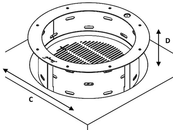
Remarque: la surface sur la quelle le brûleur sera installer doit être de niveau.
