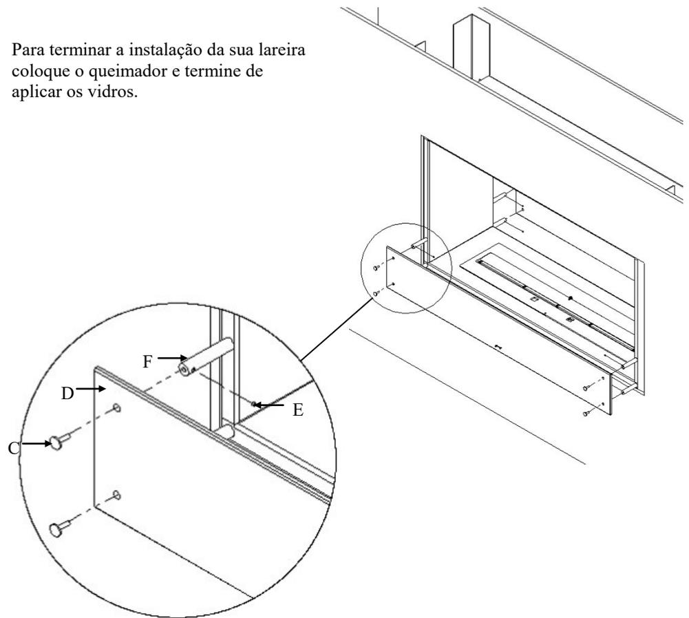
Colocar C em F e aparafusar E de modo a fixar o vidro D.
