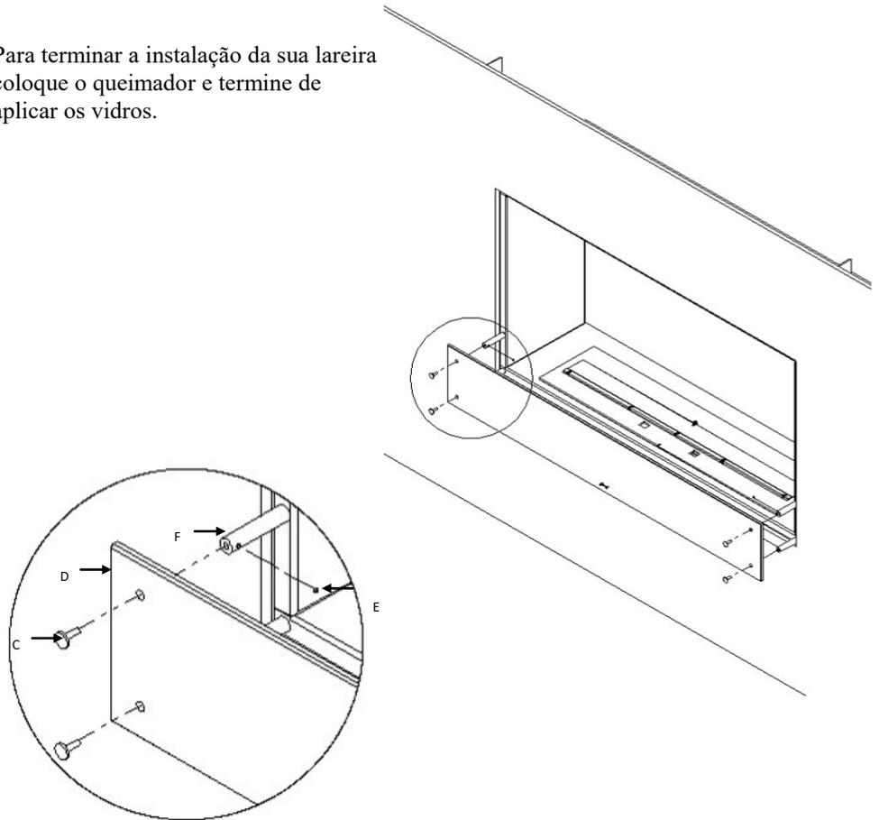
Colocar C em F e aparafusar E de modo a fixar o vidro D.
