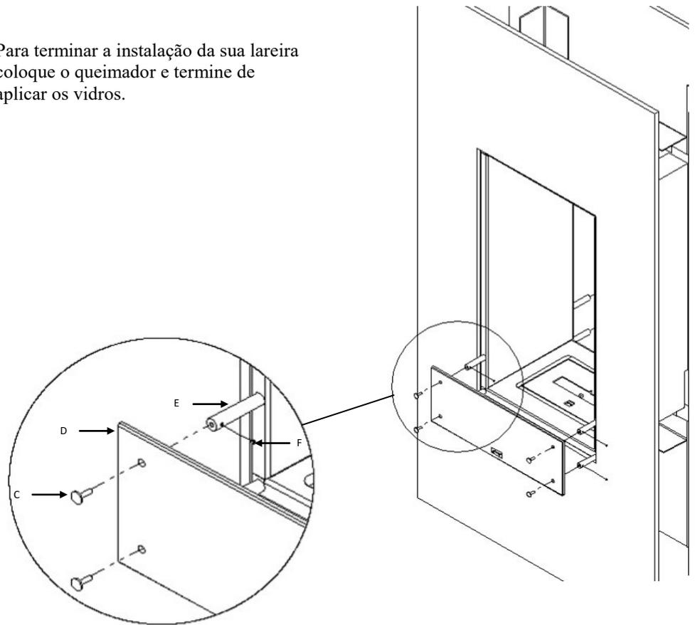
Colocar (C) em (E) e aparafusar (F) de modo a fixar o vidro (D).
