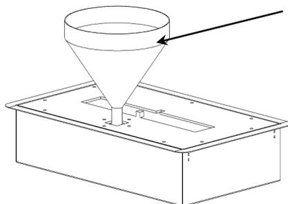
Para efetuar o abastecimento de combustível deve exercer uma força suficiente para vencer a força das molas e desta forma obter uma abertura para alimentação. Quando esta força deixar de ser exercida o orifício fica completamente fechado.
